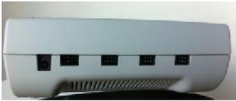
Per collegare i cavi al dispositivo inserire i connettori negli appositi alloggiamenti posizionati nella parte superiore dell'unità (vedere foto). Gli alloggiamenti sono posizionati esattamente sotto i canali corrispondenti.
