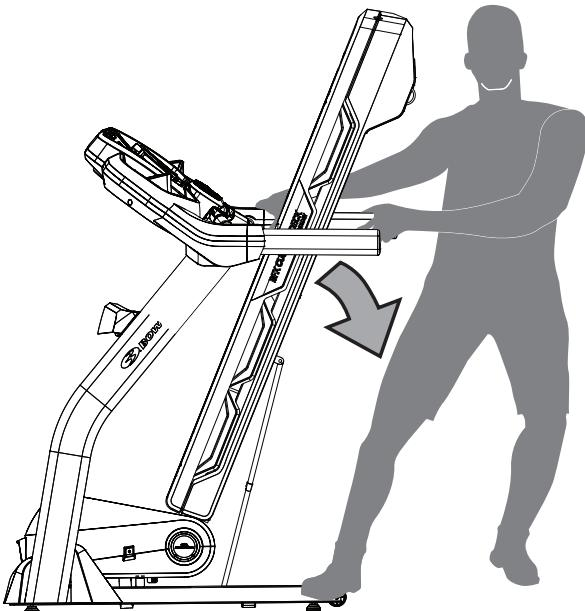
9. Afferrando il corrimano laterale e la parte anteriore del supporto verticale, ruotare in sicurezza il tapis roulant portandolo nella posizione desiderata.
