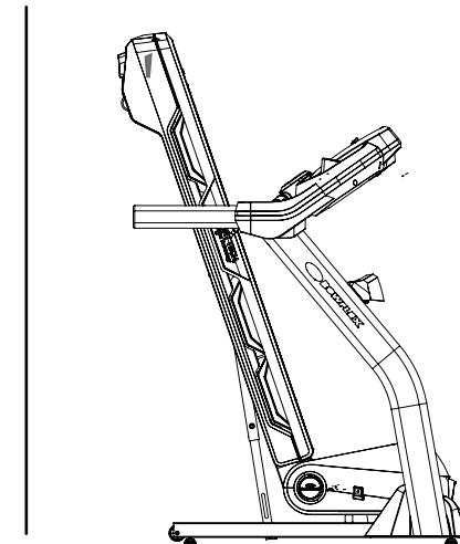
7. Verificare che il meccanismo di bloccaggio sia innestato. Prestando attenzione, tirare il nastro e assicurarsi che non si muova. In questa fase, mantenere libero il percorso di movimento nel caso in cui il blocco del tapis roulant non sia innestato.
