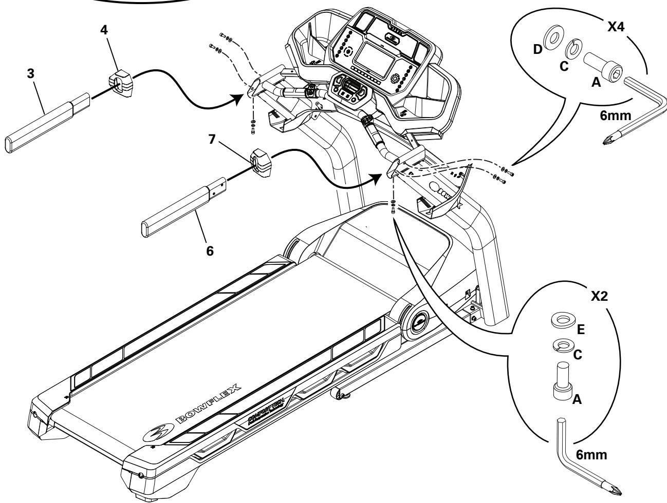
**7. Far scattare in sede le coperture raccordo inferiore e superiore e fissare la bulloneria al gruppo telaio.**
